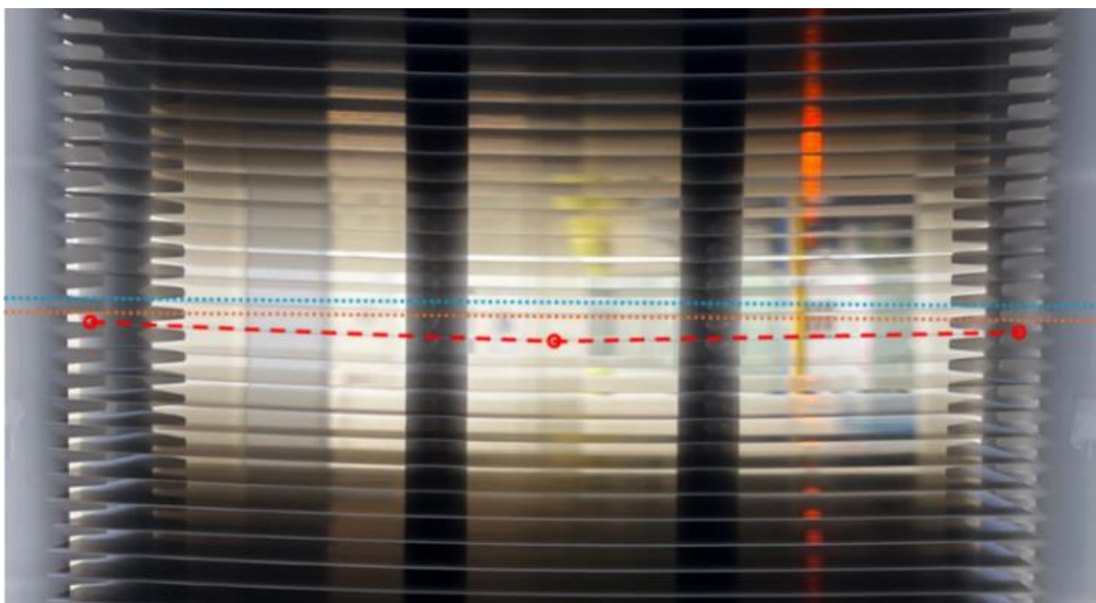
Figura 2.5 - Flexão de wafers de silício quando dispostos horizontalmente no cassete
